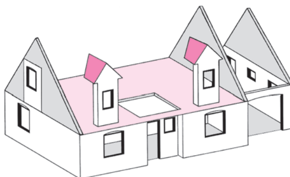
Fig. 60 : Visualisation du plancher avec trémie, jambages de mansardes et pignons
